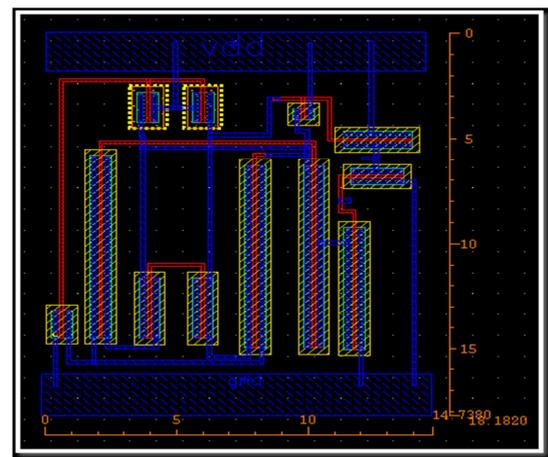
Figure 12 Layout Design Of LNA
