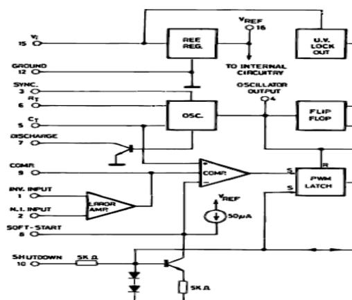
Fig 14. Soft Start Circuitry Of IC SG 3525.
